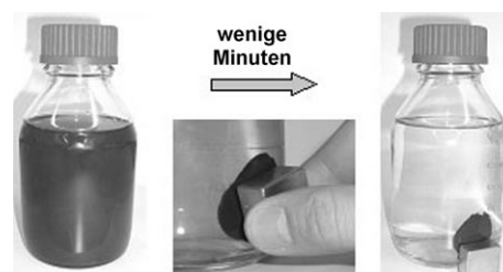
Abbildung 30. Magnetoseparation von Pd-Fe 3 O 4 -Kompositkatalysatoren zur Reinigung AOX-belasteter Abwässer (modifizierte Wiedergabe von Lit. [213]).
