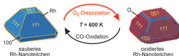
Abbildung 29. Veränderungen von Rh-NPs mit wachsenden (001)- und (100)-Oberflächen infolge der energetisch begünstigten Bildung einer Oxidhaut auf diesen Oberflächen (modifizierte Wiedergabe von Lit. [212]).
