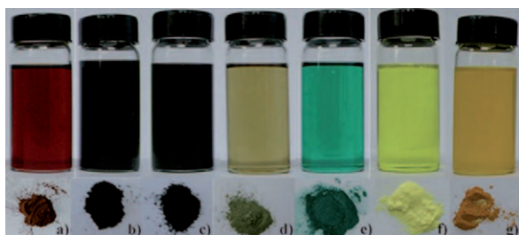
Abbildung 12. Nanopartikuläre Farbpigmente in Cyclohexan (0.1 g in 20 mL) und als Pulver: a) \alpha -Fe 2 O 3 , b) Fe 3 O 4 , c) CoFe 2 O 4 , d) ZnCo 2 O 4 , e) Cr 2 O 3 , f) BaCrO 4 , g) PbCrO 4 (modifizierte Wiedergabe von Lit.[42c]).
