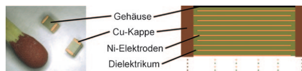
Abbildung 7. Photo und schematischer Aufbau von Dünnschichtkondensatoren, die alternierend aus je 200 Elektroden (z. B. Ni) und 200 dielektrischen Schichten (z. B. BaTiO 3 ) aufgebaut sind.
